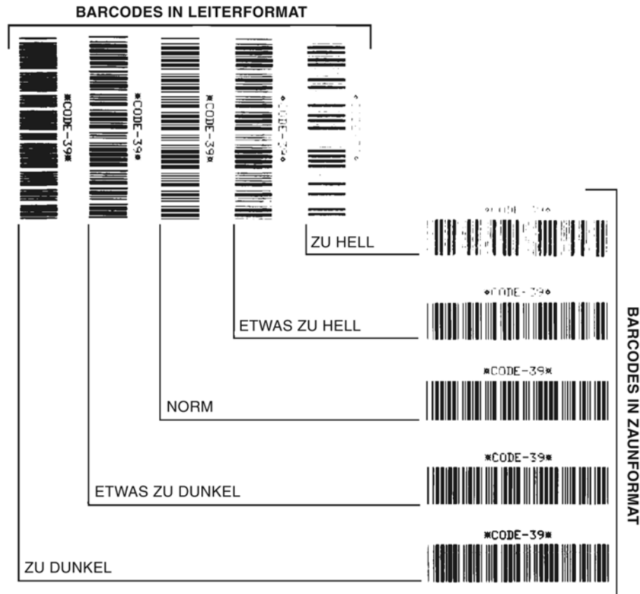
Abbildung 26 • Vergleich der Schwärzung von Barcodes
