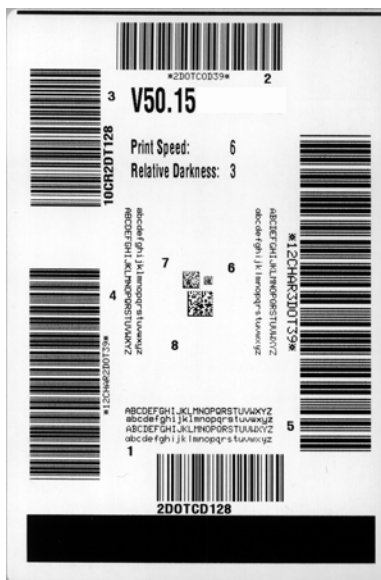
Abbildung 18 • Mit FEED gedrucktes Testetikett
