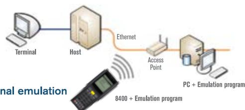
Die echte Terminalemulation des 8400 entspricht den Standards VT100/220 und TN5250. Durch das größere und hellere Display, die kompletten alphanumerischen und Funktionstasten, die hohe Akkulebensdauer und die Wireless-Funktionen kann man ganz flexibel überall bei der Arbeit auf die Leistung eines Desktop-Computers zurückgreifen.
