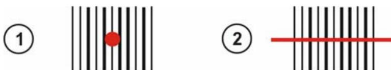
Die PowerScan® M8300 Modelle verfügen über ein programmierbares Zielsystem. Nach leichtem Drücken der Taste wird ein Zielpunkt gesendet mit dessen Hilfe der Leser so ausgerichtet wird, dass der Zielpunkt auf die Mitte des Codes zeigt (siehe Bild ①), danach wird die Taste vollständig gedrückt, der Laserstrahl erscheint (siehe Bild ②) und die Scannung erfolgt.
