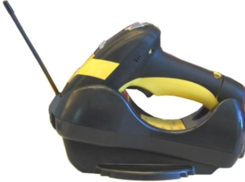
Zum wechseln des Akkus, lösen Sie die Schraube am Ende des Griffs (①) und ziehen Sie den Akkupack heraus (②), stecken Sie den neuen Akku in den Griff und verschrauben diesen. (siehe folgende Bilder).
