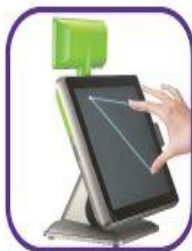
Rahmenloser Touch wassergeschützt IP66, Option: 7-Zoll-LCD-Kundendisply, Multitouchfunktion mit Windows 7
